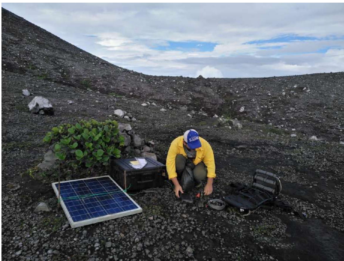
En esta fotografía del 13 de noviembre del 2019, se muestra la preparación para la instalación de un equipo GNSS en una de las laderas del cono Von Seebach. Fotografía por Arturo Ramos, del ICE.
