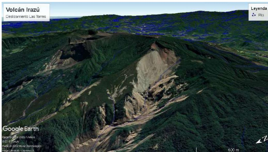
Imágenes del volcán Irazú y el deslizamiento de Las Torres, obtenidas de Google Earth. Se observa la fuerte erosión que se da en este sector debido a las fuertes pendientes y presencia de material muy meteorizado y poco consolidado.
