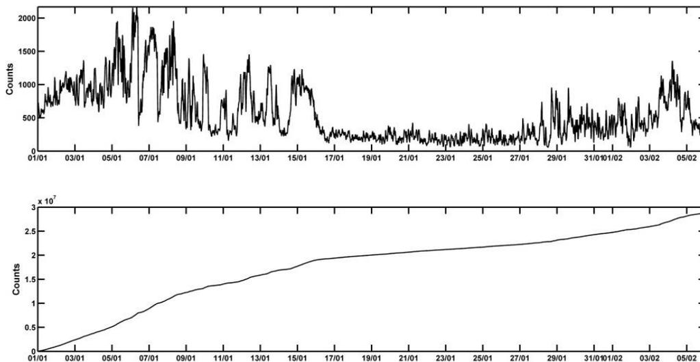
**Figura 1. Nivel de actividad sísmica promediado cada 10 minutos (arriba) y acumulado (abajo) con base en el promedio cuadrático de la amplitud sísmica (RSEM) para el 2017. Registros de la estación CVTR de la Red Sismológica Nacional (RSN: UCR-ICE).**
