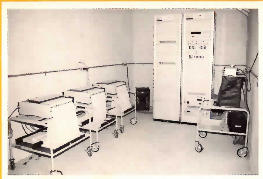
Foto 1. Observatorio sismológico de La Lucha, (LCR2), con registros de período corto, medio y largo, para las tres componentes.
